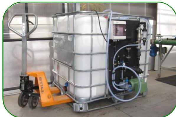
La tecnología que se muestra al lado se puede colocar con una unidad de mesa de montaje en un tanque de agua de 1.000 l, un pulverizador de carro o un contenedor de CC. Se requiere una conexión a una corriente alterna de 230 voltios y el uso de un compresor con una presión de aire dinámica de hasta 6 bares y una capacidad de al menos 250 litros/minuto.
